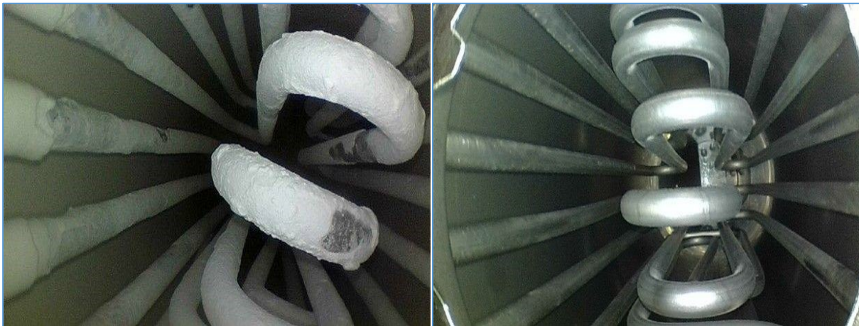
Abb. 55: Verkalkte und entkalkte Heizkörper im Dampfgenerator (© Rational AG)
