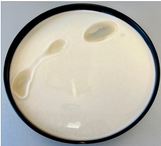
Abb. 60: Wirkung der Hotspots auf einen einfachen Wasser-Mehlteig. Deutlich sind die gegarten Bereiche zu erkennen, deren mittlerer Abstand ziemlich genau der halben Wellenlänge von ca. 6 cm entspricht. Der Drehteller wurde für dieses Foto entfernt, und die Mikrowelle wurde bei voller Leistung für rund 30 Sekunden betrieben. Hinweis: Die Verteilung der Hot- und Coldspots ist bei jedem Gerät anders und kann durch diesen Test sehr einfach festgestellt werden. (© S. Skorupka)
