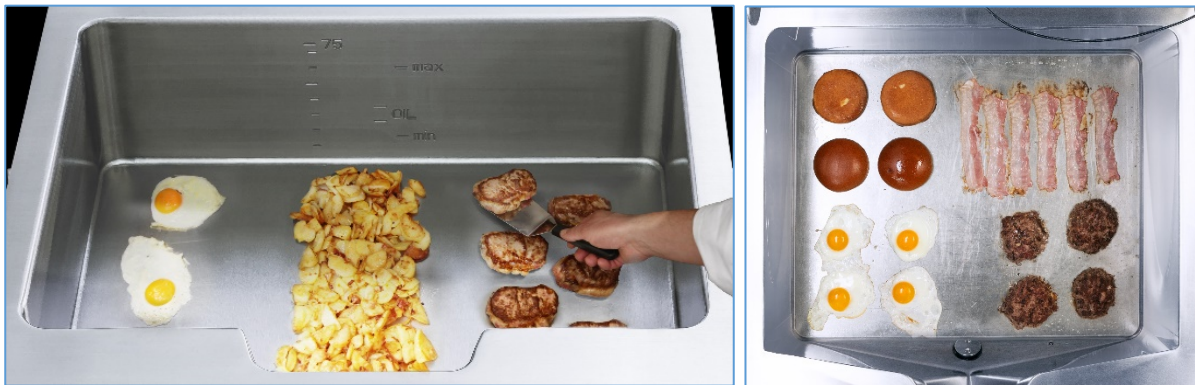
Abb. 23: Unterschiedlich beheizte Garzonen für Bratprodukte mit unterschiedlichen Temperaturanforderungen (links: © MKN GmbH & Co. KG; rechts: © Rational AG)
