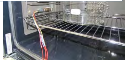
Abb.: im Backofen befestigte Sonde
