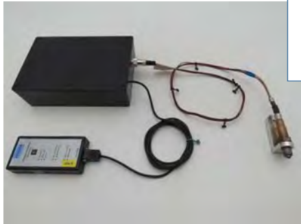
Abb.: Messaufbau mit Sonde, Sondenhalterung und Elektronik
