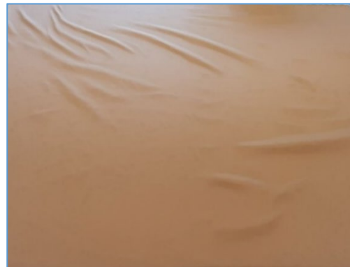
Abb. 2: Polyester-Stoff nach der Waschung mit dem optimierten Schleudergang sowie die Behandlung durch Bedampfen und Glätten
