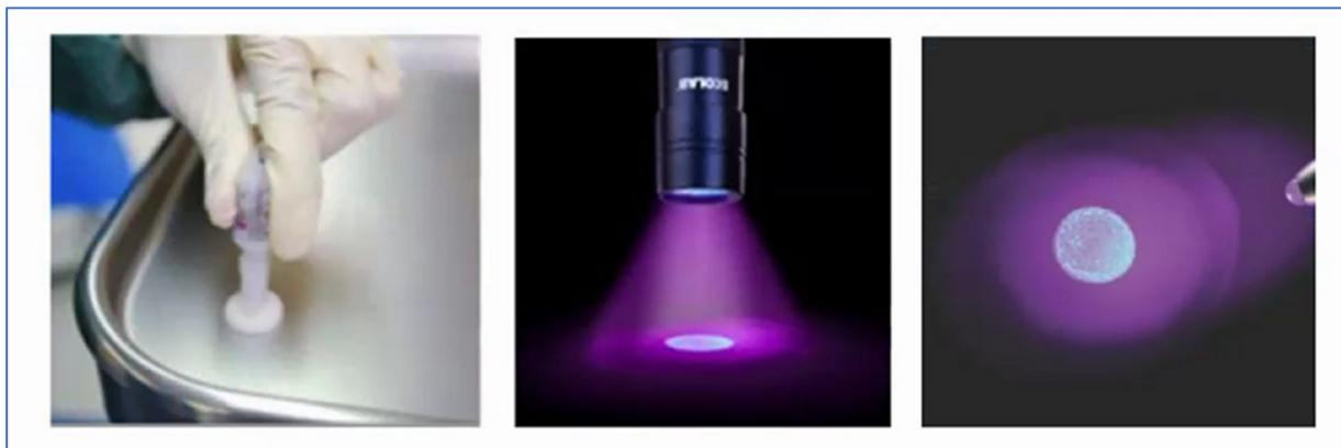
Abb. 1: Applikation eines fluoreszierenden Markierungsgels und Sichtbarmachung unter UV-A Schwarzlichtquelle (Ecolab Healthcare)
